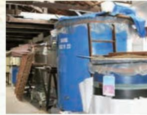
▲蔵の内部にある仕込みタンク。蒸した米と麹と水を入れ、酵母をじっくりと醸していく
